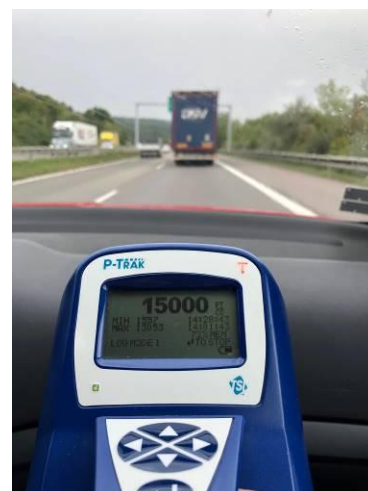
Obr. 17: Znečistenie ovzdušia ultrajemnými časticami vo vnútri auta na diaľnici z Trnavy do Trenčína (nízka hustota dopravy, 20.09.2022)
