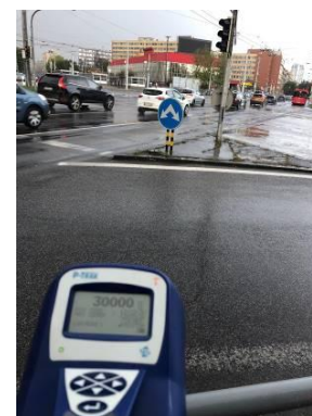
Obr. 12: Meranie znečistenia ovzdušia ultrajemnými časticami z dopravy v blízkosti monitorovacej stanice kvality ovzdušia na Trnavskom Mýte a porovnanie s meraním na rovnakom mieste v 2015
