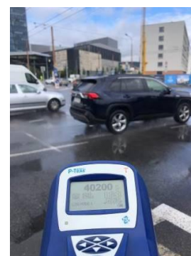
Obr. 11: Meranie znečistenia ovzdušia ultrajemnými časticami z dopravy na križovatkách v Bratislave. Dopravne výrazne zaťažená križovatka: Mlynské Nivy, Košická ulica. Dopravne málo zaťažená križovatka: Americké námestie.
