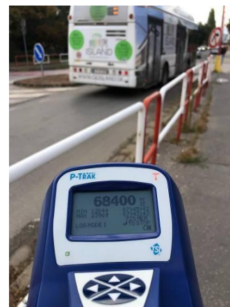
Obr. 14: Znečistenie ovzdušia ultrajemnými časticami na rušnejšej ulici pri ZŠ J. Bottu v Trnave v porovnaní so znečistením v tichom historickom centre Trnavy
