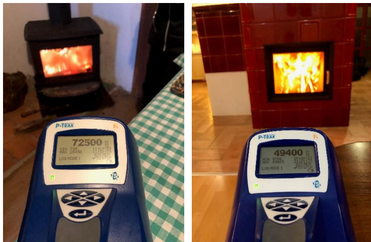
Obr. 33: Znečistenie ovzdušia v interiéri v dôsledku spaľovania dreva v modernom krbovom kotli.
