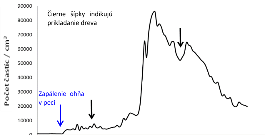
Obr. 34: Znečistenie ovzdušia v interiéri v dôsledku spaľovania dreva v novej teplovzdušnej peci.
