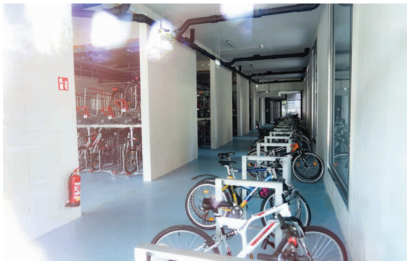
Obr.24 ▲ Pohľad do bicykliarne. Kvôli obmedzenému priestoru sa používajú dvojpodlažné stojiská. 📍 Seestadt, Viedeň.
