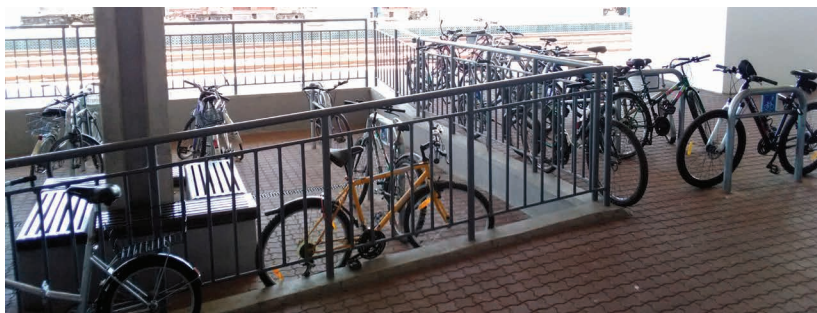
Obr.27 ▲ Optimálne parkovanie bicyklov priamo na peróne, v tesnej návaznosti na vlak. Použité sú kvalitné U-stojany priamo pod strechou, ich počet je však zjavne nedostačujúci. 📍 Železničná stanica Nové Mesto nad Váhom.
